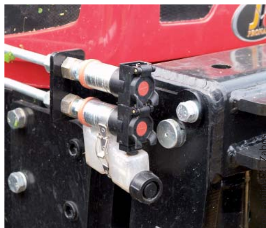
Pronar 6180 wyposażony jest w przedni most firmy Dana. Kąt skrętu wynosi 55°. Przedni TUZ, dostępny za dopłatą, ma udźwig 4000 kg. Wyposażono go w jedną parę wyjść hydraulicznych i instalację hydrauliczną. Dostępny jest również przedni WOM
