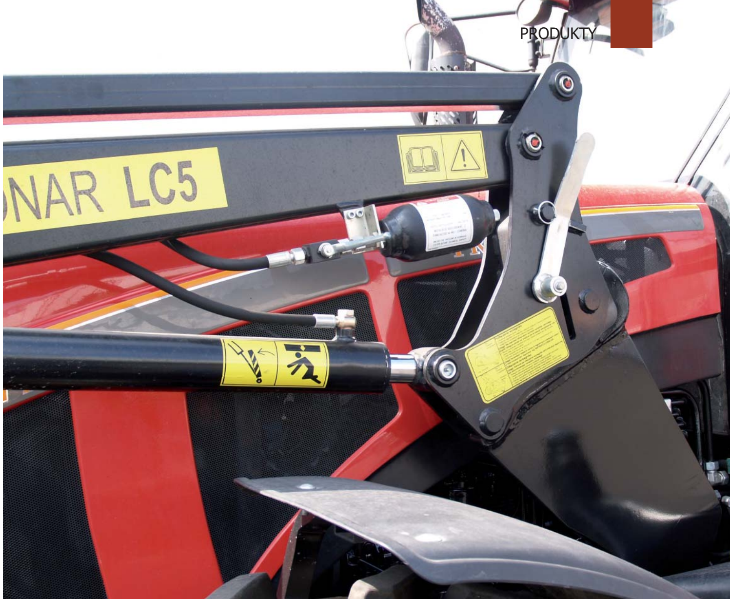
Solidne wsporniki omijają punkty serwisowe ciągnika
