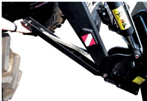
Szerokie podpory zamontowane na stałe w wysięgniku ładowacza pozwalają na szybkie i bezpieczne odstawienie ładowacza
