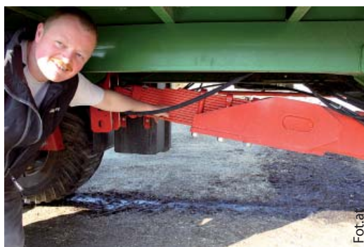
Dyszle jest amortyzowany resorem piórowym
