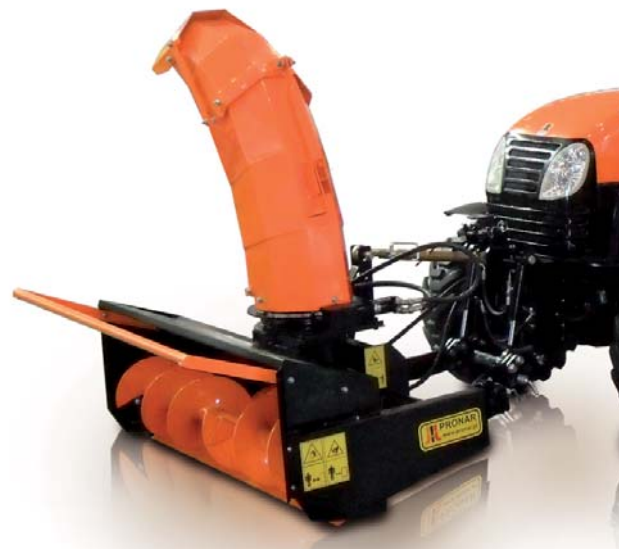
Odśnieżarka OW1.5 posiada TUZ wg ISO 730-1 kategorii I - II i wymaga mocy WOM-u 25-60 KM oraz jego obrotów nie mniejszych niż 540 na min
