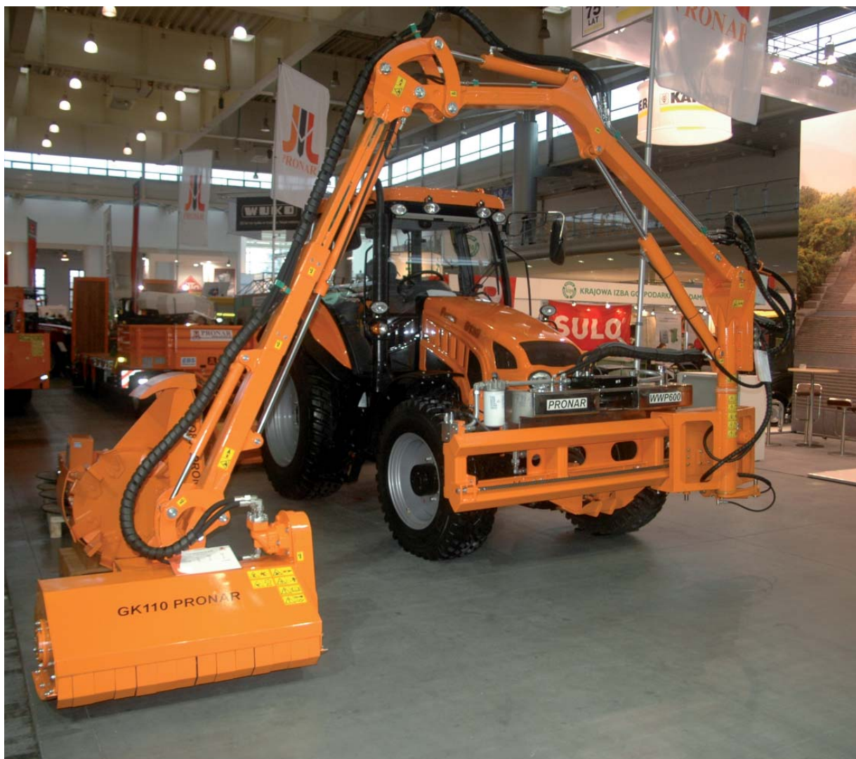
Ciągnik PRONAR 5135 wyposażony w wysięgnik wielofunkcyjny PRONAR WWP 600 z agregowaną głowicą koszącą PRONAR GK110
