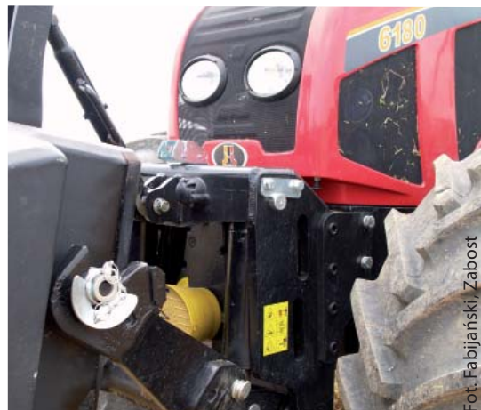
Pronar 6180 wyposażony jest w przedni most firmy Dana. Kąt skrętu wynosi 55°. Przedni TUZ, dostępny za dopłatą, ma udźwig 4000 kg. Wyposażono go w jedną parę wyjść hydraulicznych i instalację hydrauliczną. Dostępny jest również przedni WOM
