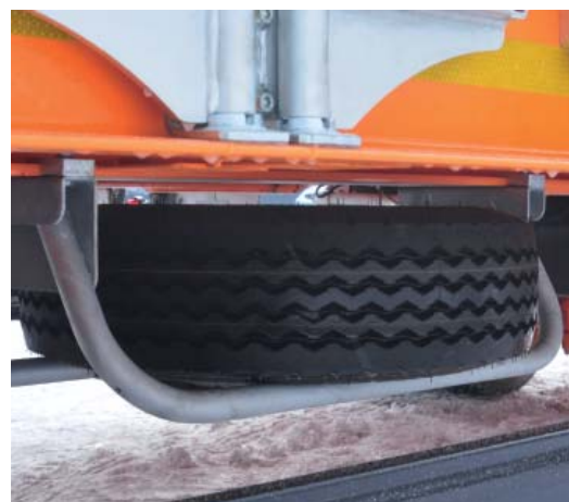
Koło zapasowe zamontowane pod podłogą przyczepy
