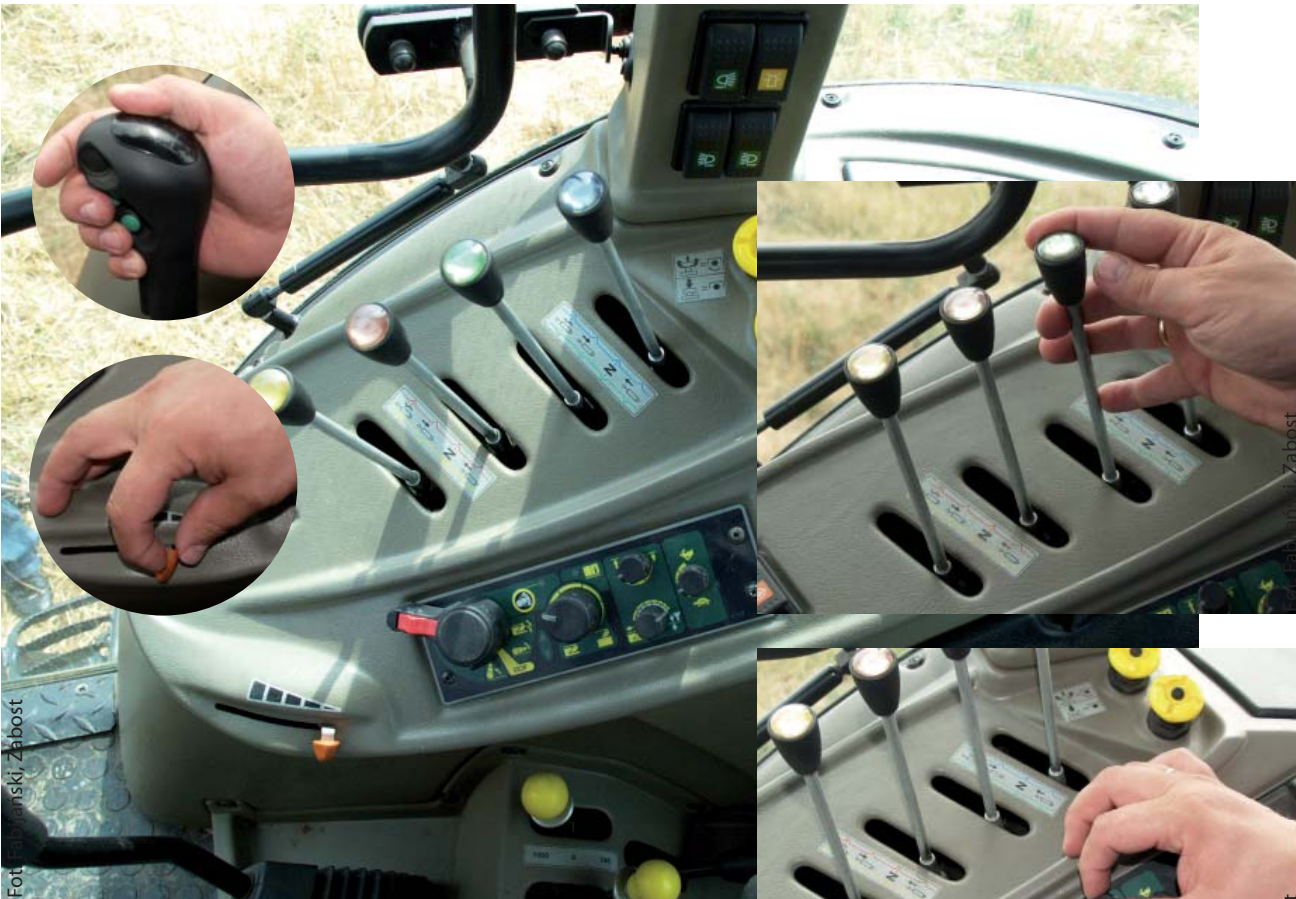
Naprawymłotnikuznajdujesięwiększośćdzwigniiprzelącznikówwelektrohydraulicznych sterującychukładamiciągnika.Podnośnikobsługujesięzapomoczączytelnegopanelu sterowania, wyposażonego w EHR
