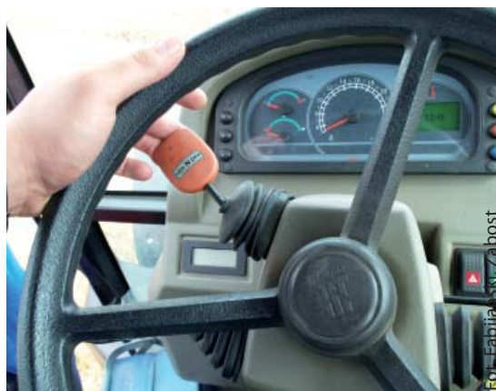
CiągnikiP10sąwyposażonew czytelne zegary analogowe iniewielkiwyświetlaczcyfrowy. Kierownicaregulowanajestw dwóch poziomach. Z lewej stronyznajdujęsięhydrauliczny rewers
