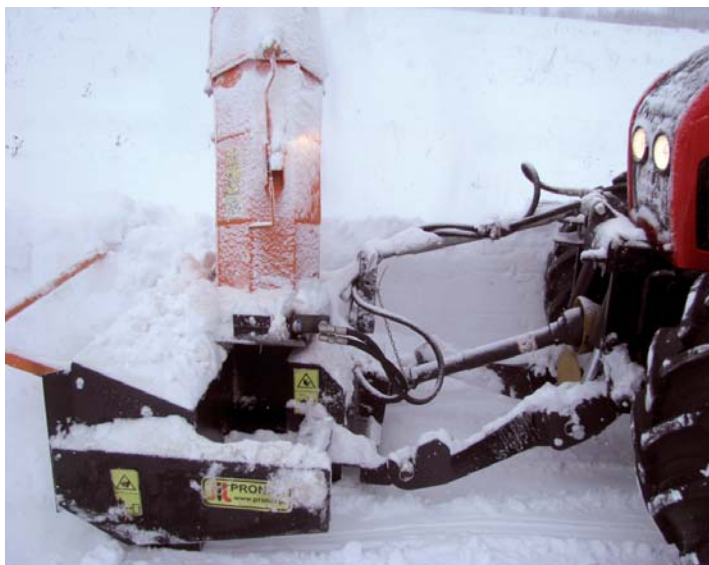
Odśnieżarka OW1.5 posiada TUZ wg ISO 730-1 kategorii I - II i wymaga mocy WOM-u 25-60 KM oraz jego obrotów nie mniejszych niż 540 na min
