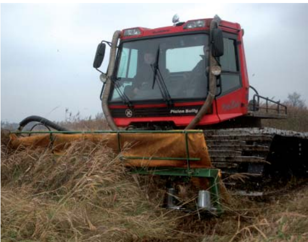
Wykasanie terenów bagiennych wymaga specjalistycznego sprzętu. Na zdjęciu: zmodernizowana kosiarka czołowa Pronaru PDF380R
