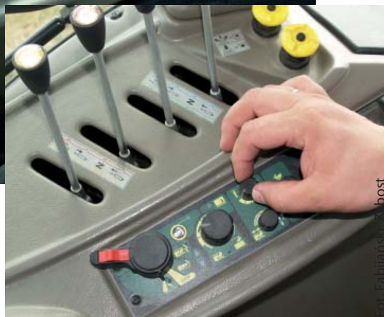
Naprawymłotnikuznajdujesięwiększośćdzwigniiprzelącznikówwelektrohydraulicznych sterującychukładamiciągnika.Podnośnikobsługujesięzapomoczączytelnegopanelu sterowania, wyposażonego w EHR
