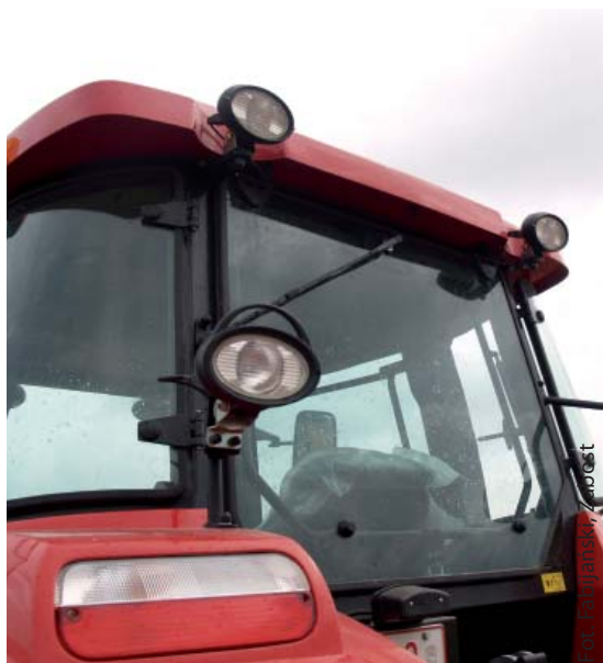
Dużym plusem kabiny w Pronarze P10 jest doskonała widoczność we wszystkich kierunkach. Poza przednią i tylną parą reflektorów roboczych dyspozycji pakiet reflektorów roboczych
