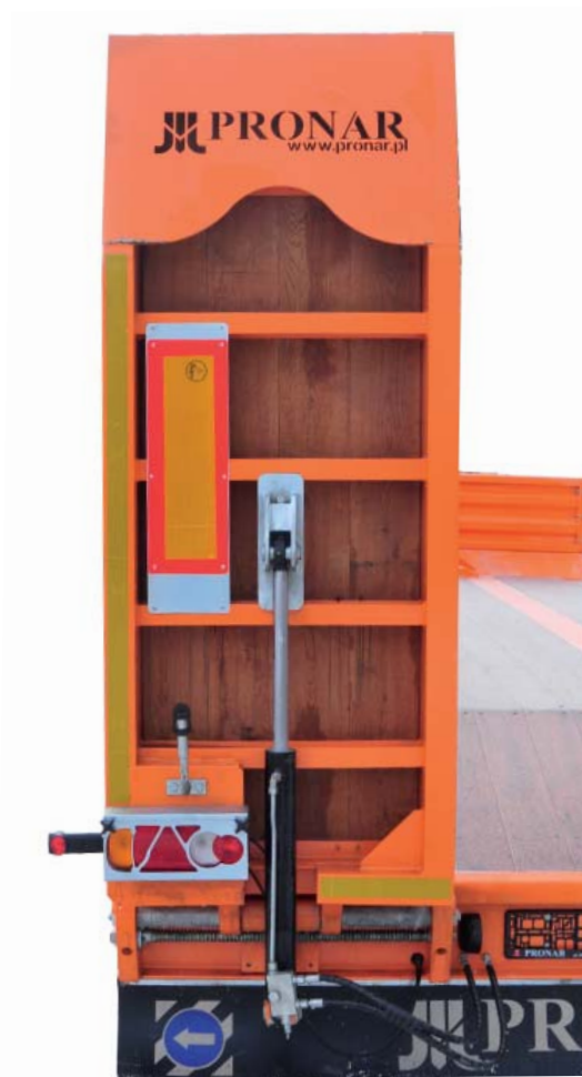
Hydrauliczny system opuszczania/podnoszenia najazdów montowany w wersji standardowej
