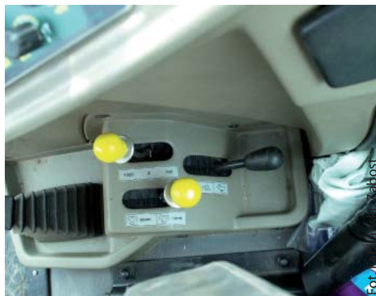
Pomiędzyprawymłotnikiem a siedzeniem operatora znajdujęsiędzwigniesterujące WOM orazdzwigniareduktora biegówpełzających
